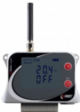
GSM datalogger je určen pro záznam teploty ze dvou externích sond a dvou dvoustavových vstupů. V případě překročení nastavených mezí umožňuje zasílání alarmových SMS a JSON zpráv přes GPRS datové připojení. Měřené hodnoty mohou být zasílány do internetového úložiště [COMET Cloud](#), což je kompletní monitorovací, alarmovací a analytický systém.
